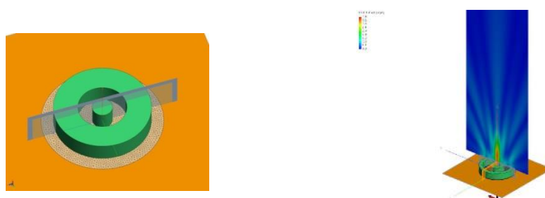
Fig. 8 - Simulazione FEKO del campo vicino per la TP4 a 20 GHz. Gli anelli verdi rappresentano il materiale dielettrico
