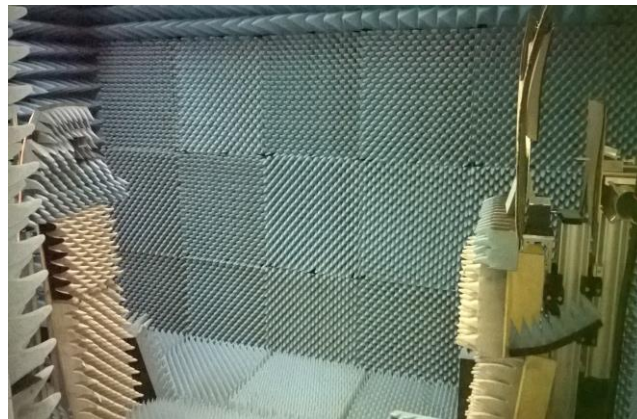
Fig. 17 - Camera anecoica: setup sperimentale per i test di laboratorio con \nu = 20 GHz. L'emettitore (antenna a tromba rettangolare) è visibile a sinistra, circondata da coni assorbenti. A destra si può vedere lo schermo con il foro circolare su cui è inserita la TP.
